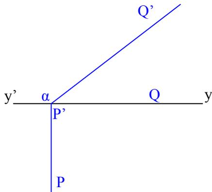
3.b) l'épure d'un plan vertical V défini par les droites (D) et ( $\Delta$ ) (sur 4)
