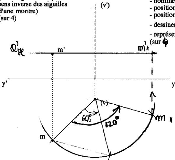
7) **Rotations** : soit la droite de bout (Δ), soit la droite (D). Par une rotation d'angle  $\theta$  autour d'un axe vertical (V) amener (D) à rencontrer (Δ) soit I le point invariant entre (D) et (D<sub>1</sub>) dans la rotation  $\theta$ . soit M<sub>1</sub> le point par lequel (D<sub>1</sub>) rencontre (Δ) soit M le point dont M<sub>1</sub> est le transformé par la rotation  $\theta$
