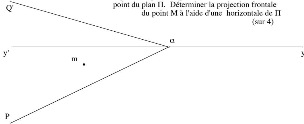
3/ soit un plan  $\Pi$  représenté par ses traces  $P\alpha Q'$  . Soit M un point du plan  $\Pi$ . Déterminer la projection horizontale du point M à l'aide d'une horizontale de  $\Pi$  (sur 4)
