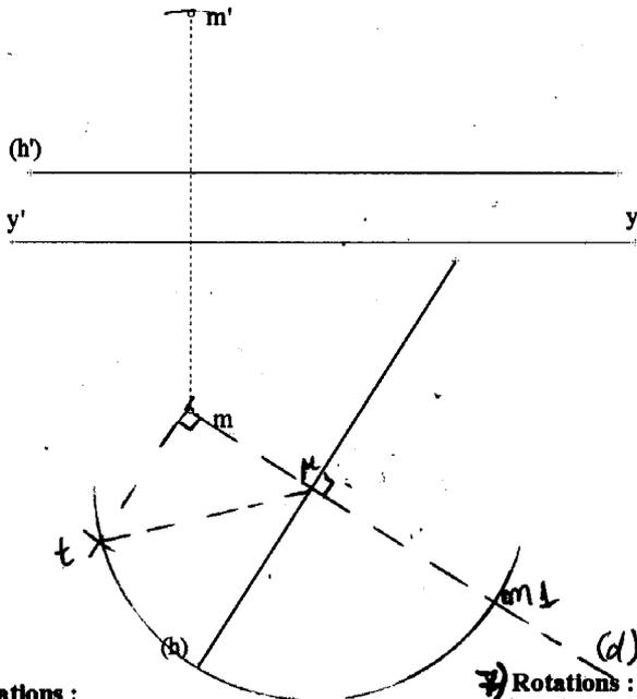
6) **Rotations** : Soit le point M, soit l'axe de rotation vertical (V). Calculer le point M<sub>1</sub> résultant d'une rotation d'angle  $\theta = 120^\circ$  (sens trigonométrique) autour de l'axe (V). (sens trigonométrique = sens inverse des aiguilles d'une montre) (sur 4)
