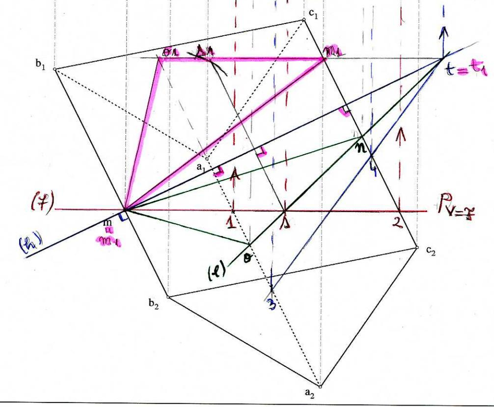
③ Construire  $(H)$  une horizontale du plan  $\Pi$ , passant par le point  $M$  :
